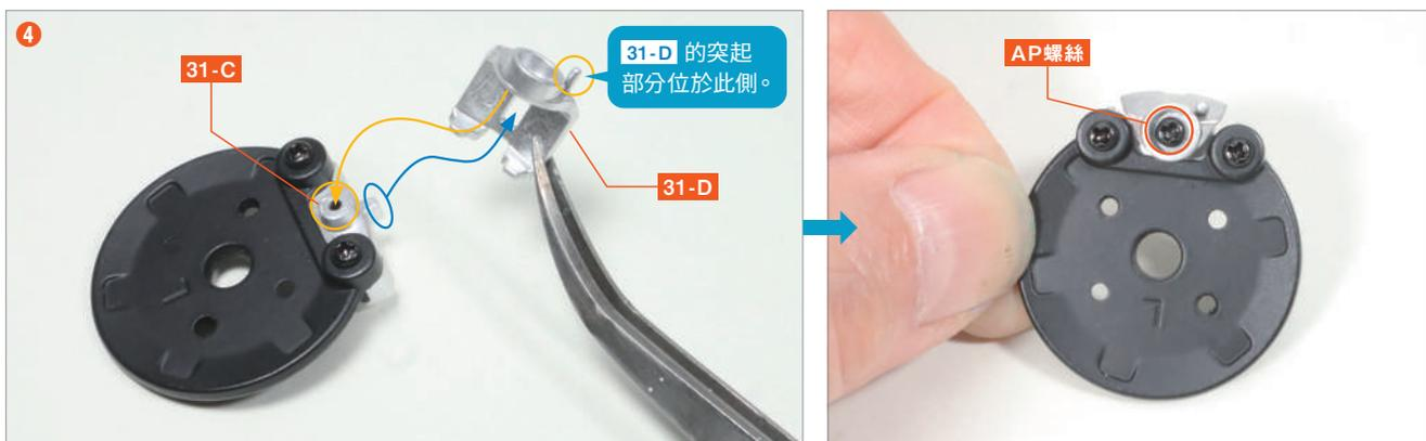
將後輪煞車卡鉗 (2) · L 31-D 的四角孔和螺絲孔與 31-C 的突起部分對齊，使用 AP 螺絲 固定。
