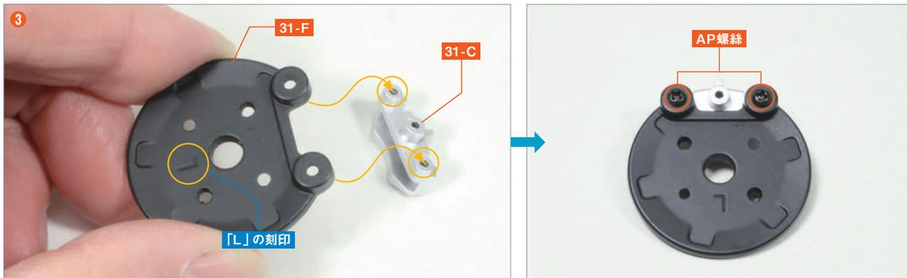
將後輪煞車卡鉗 (1) 31-C 的螺絲孔突起部分與後輪煞車碟盤防塵蓋 (L) 31-F 的凹槽對齊，使用 AP 螺絲 在兩個位置固定。
