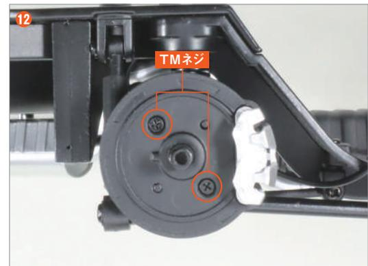
與步驟 8 相同方式，使用第24期提供的十字螺絲起子 0 號，用 TM 螺絲 將 2 個地方固定。
