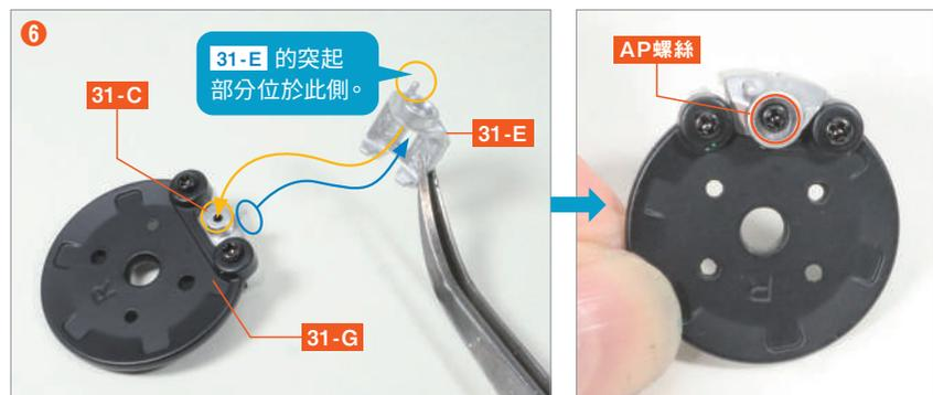
與步驟 4 相同方式，將後輪煞車卡鉗 (2) · R 31-E 的四角孔和螺絲孔與 31-C 的突起部分對齊，使用 AP 螺絲 固定。
