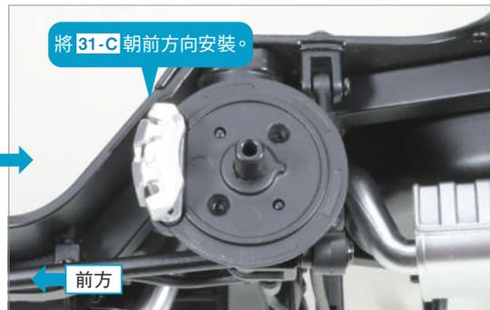
備妥已組裝至第29期的底盤，將後軸殼下側 26-A 的前端大突起部分和2個小突起部分，對準 31-F 的洞孔嵌入。
