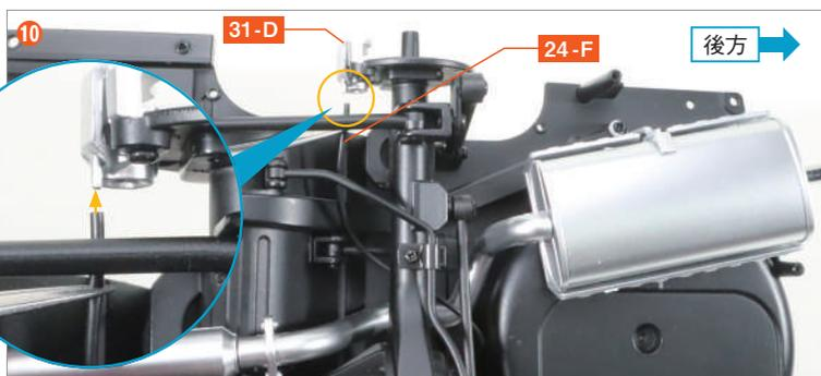
將 24-F 的前端插入 31-D 的突起部分中。如果 24-F 過長，可以剪短約30mm。
