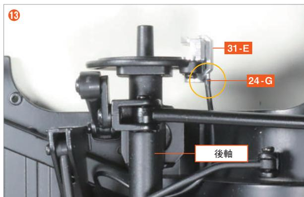
與步驟 9 相同方式，將底盤翻至正面，從後軸下方穿過並拉出後煞車軟管 No.4 24-G。然後，將 24-G 的前端插入 31-E 的突起部分。如果 24-G 過長，可以剪掉約 35mm。
