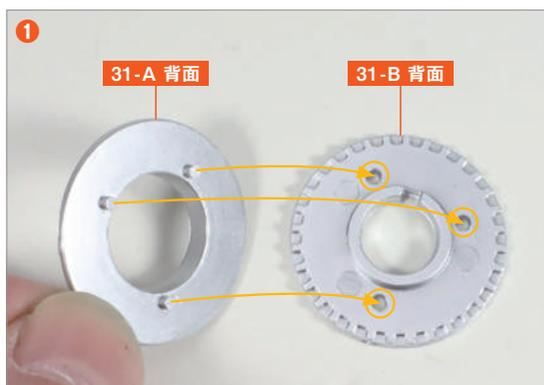
將後輪煞車碟盤 (1) 31-A 的背面3個突起部分，對準後輪煞車碟盤 (2) 31-B 背面的3個凹槽，並將其嵌合。
