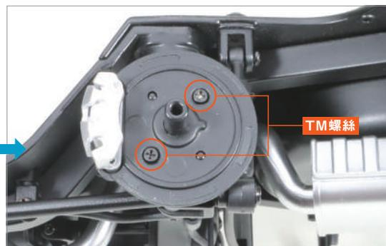
使用第24期提供的十字螺絲起子 0號，使用 TM螺絲 在2個位置進行固定。
