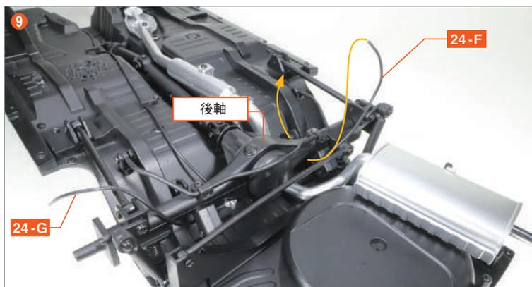
將底盤翻至正面，從後軸下方穿過並拉出後煞車軟管No.5 24-F。
